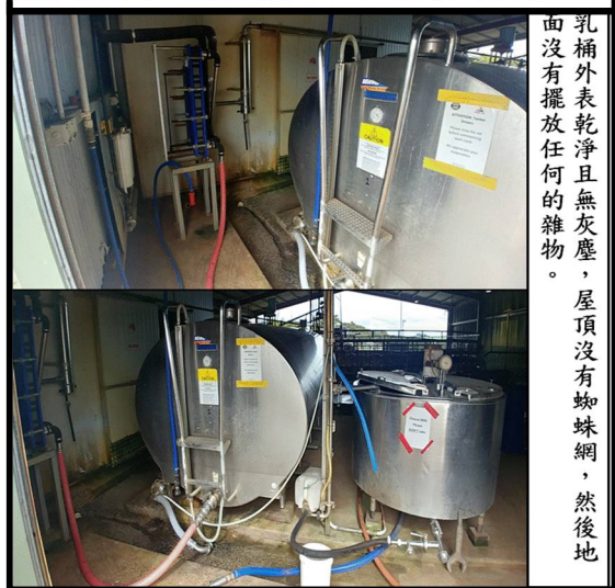
榨乳室應持清潔乾燥、足夠的亮度，並且在CIP清洗後應將部分管路拔除風乾，降低細菌的生長可能。
